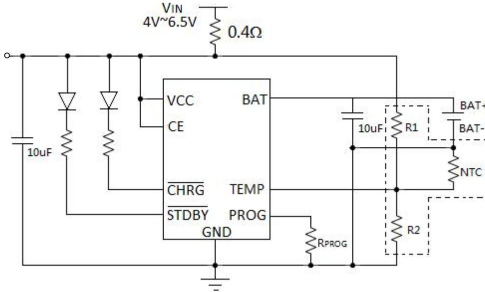
其中，虚线框出R1/R2/NTC电阻部份为电池温度监测，可选。也可TEMP脚直接接地，不监测电池温度
